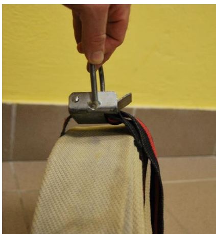
PRAVILNO ZAPET CEVNI NOSILEC
