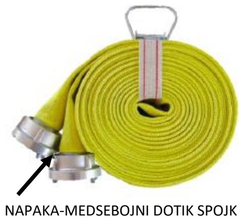
Slika 10: Prikaz napake: če zgornja spojka sega preko spodnje spojke (šteje že medsebojni dotik spojke).
