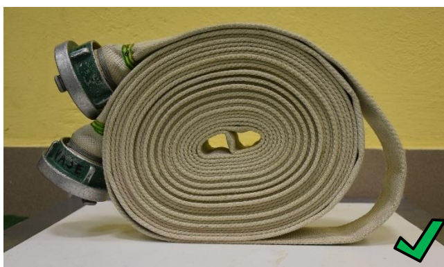
Slika 13: Pravilno zvita C-cev z dovoljeno ohlapnostjo.
