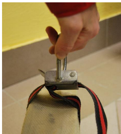
NEPRAVILNO ZAPET CEVNI NOSILEC
