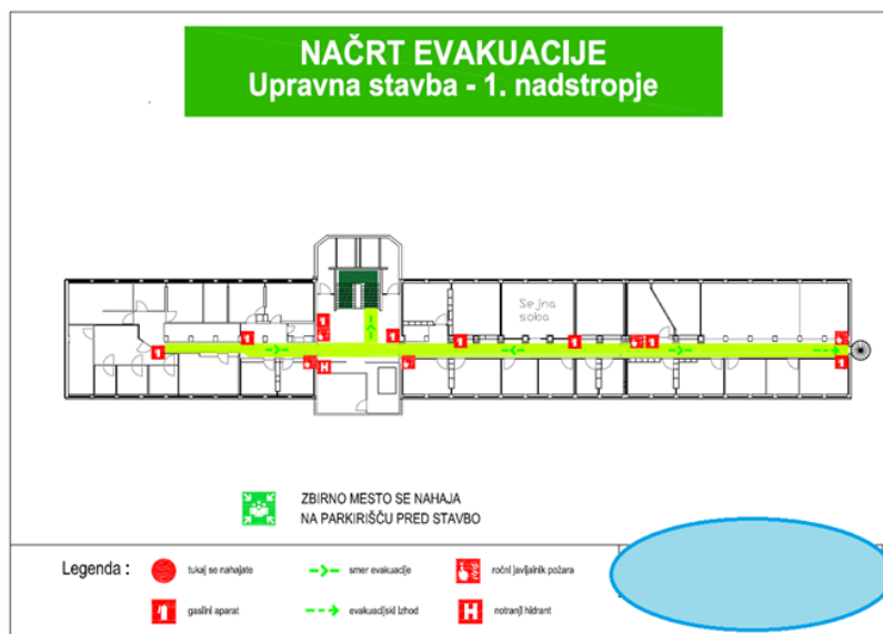
Slika 2: Načrt evakuacije enostavnejšega objekta
